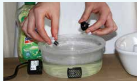
6) Alle Elemente mit warmem Seifenwasser reinigen und bei stärkeren Verschmutzungen in Essig einweichen / Clean all elements with warm soapy water
