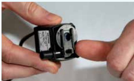
4) Motorgehäuse herausziehen / Pull out the engine housing
