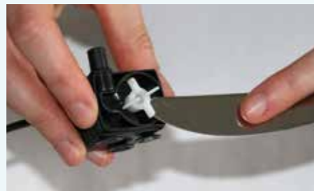
5) Inneren, magnetisch fixierten Propeller herausziehen / Pull out the inside, magnetically fixed propeller
