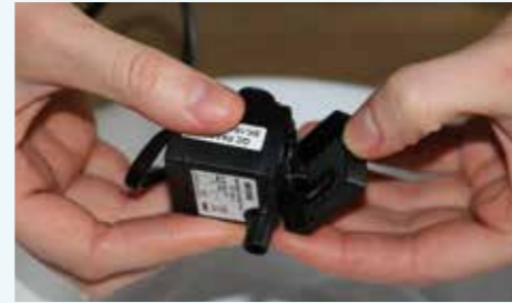
3) Untere Schutzplatte des Motors herausziehen / Pull out the lower protective plate of the engine
