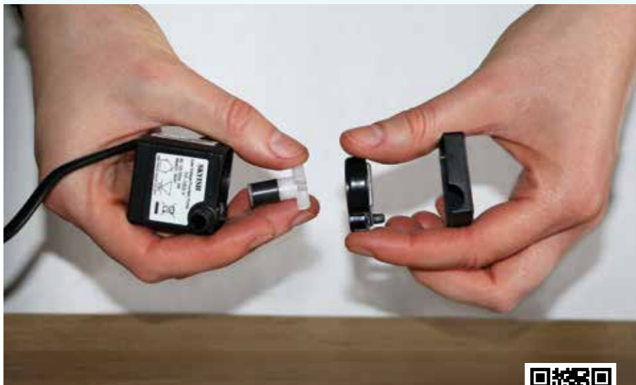
7) Motor wieder zusammenbauen / Reassemble the engine
